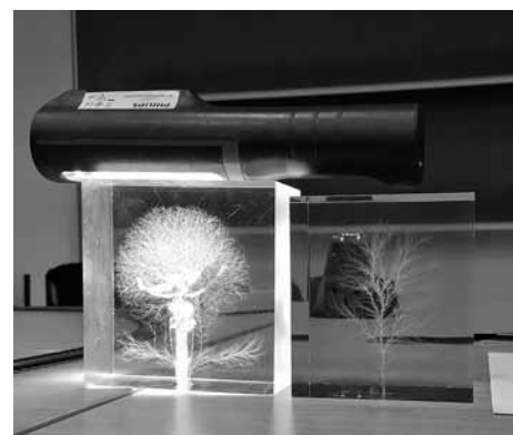
Plexisklo, do kterého byl puštěn svazek elektronů přes urychlovač částic
