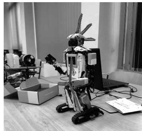
Robot z Lega se senzory pohybu, který při zaznamenání pohybu začne "útočit" (točit vrtulí)
